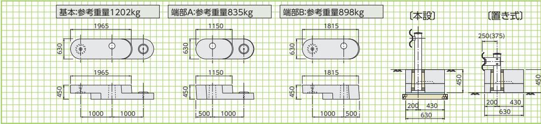
■B型(400×450) 支柱間隔 2.0m、1.5m、1.0m
