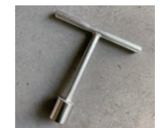
T 型レンチ 連結ボルトの締結に使用します。
