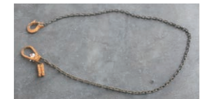
チェーンスリング 底版部のチェーンの長さ調整に使用します。
