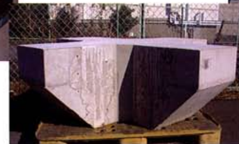
「十字型ユニット完成状況」 （注：実際の施工現場にて生コン打設を行います。）
