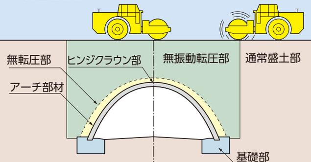
※テクスパン工法は、一般的に内空高が高く（車道使いの建築限界高さ4.7m程度）土被りが高い（1m～20m）用途に使用されます。
