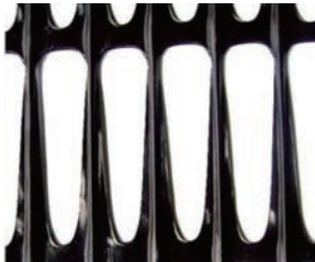
■アダム HG 高密度ポリエチレンの格子状ネットにアラミド繊維を挿入・補強したグリッド。高強度かつ低伸度で、クリープひずみも小さく、盛土や地盤の補強に最大の威力を発揮します。
