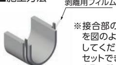
※接合部の雄に、フリームパッキンを図のように張り付けてから、セットしてください。雄部と雌部がうまくセットできる寸前で剥離用フィルムを取り除いてください。
