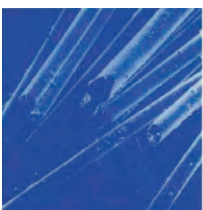
〈ガラス長繊維〉 太くて長く、折れても太さが変わらないため吸入されにくい
