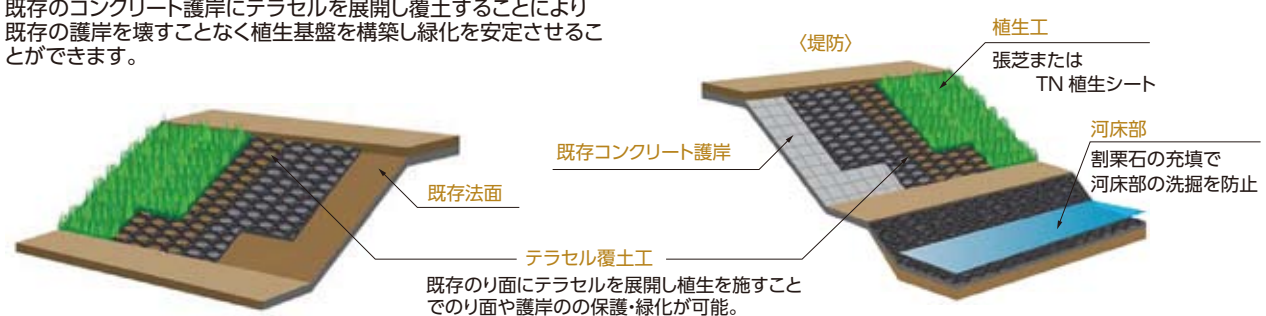
施工イメージ
