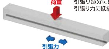
引張り部分に鉄筋を配置して引張り力に抵抗する。
