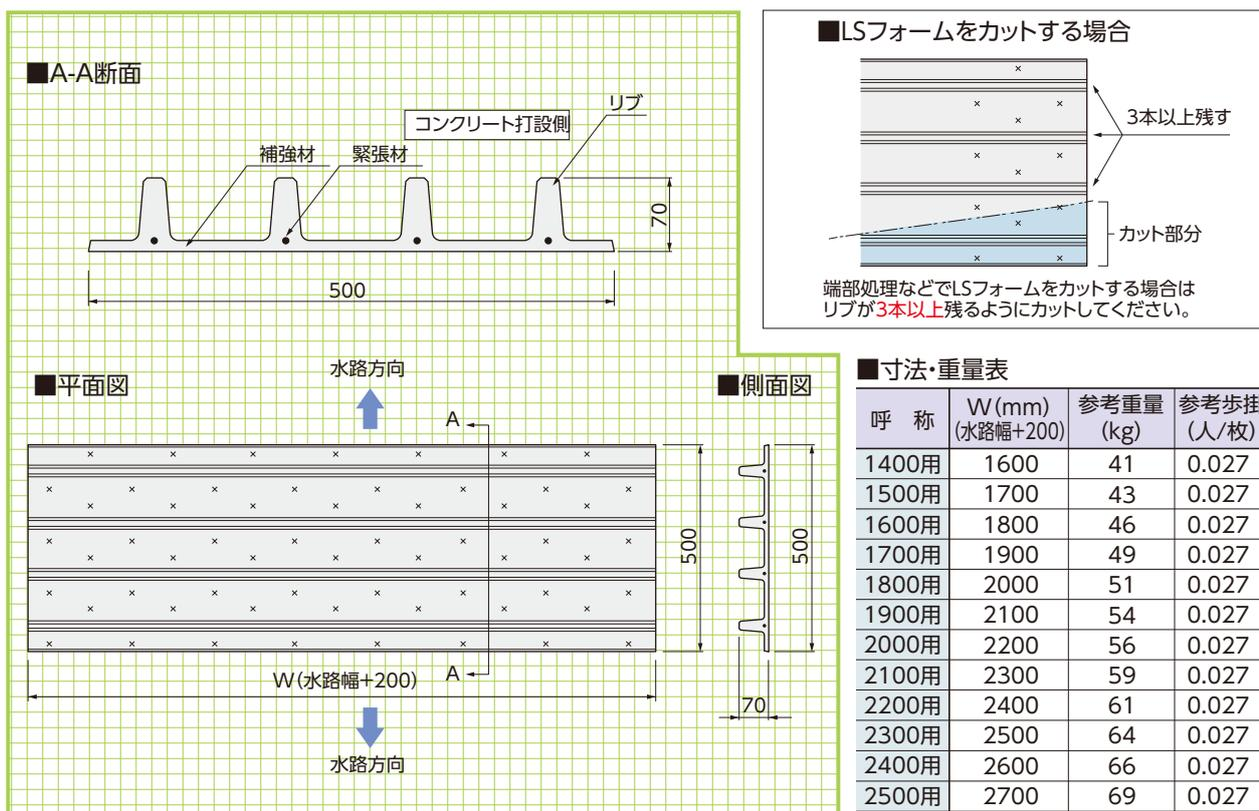
※施工時はリブが上(打設面)となるように敷設してください。
