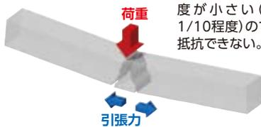
コンクリートだけは引張り強度が小さい(圧縮強度の1/10程度)ので、引張り力に抵抗できない。
