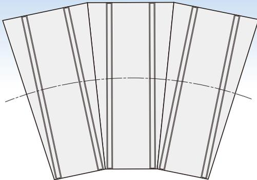
■下図に示すようにJSフォームをカットする場合、リブ部よりのとび出しの寸法は、200mmを最大とします。
