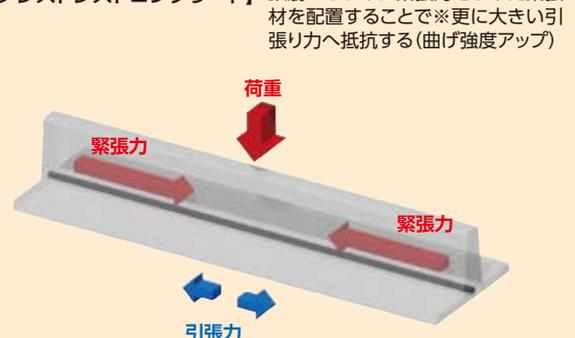
鉄筋のかわりに緊張力をかけた緊張材を配置することで※更に大きい引張り力へ抵抗する(曲げ強度アップ)
