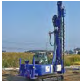
施工機械 リーダー式打設機
