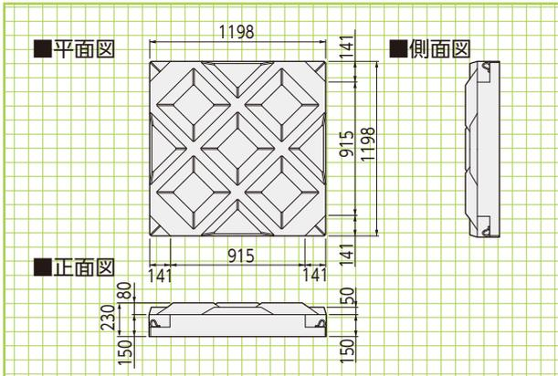
すり付けブロック(コンクリート体積:0.187m<sup>3</sup> 参考重量:374kg)
