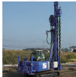
施工機械 リーダー式打設機
