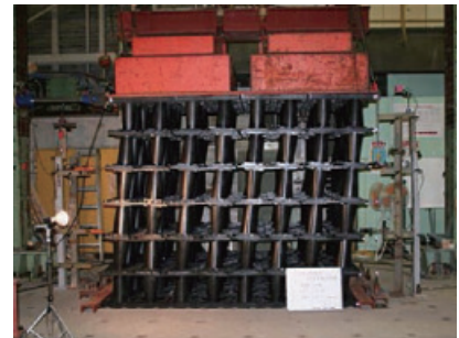
各種試験を実施(写真は交番載荷試験)
