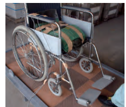
▲振動試験計測状況
