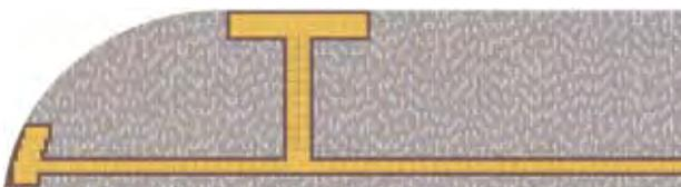
プラストの「サンド」「オーカー」を基調にした舗装パターンだが、「誘導ブロック」の両脇にスタンダードの「ダークブラウン」を敷設する事で、輝度比を強調。
