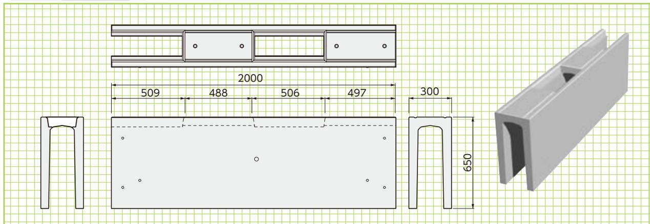
**端部型** 参考重量=215kg 充填コンクリート量:0.104m<sup>3</sup>
