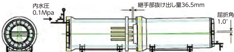
更正後の鉄筋コンクリート管の継手部に、地盤の永久ひずみ1.5%による抜け出し量36.5mmおよび地盤沈下による屈曲角1.0°を同時に与えた後、0.1Mpaの内水圧を3分間負荷し、漏水がないことを確認しました。
