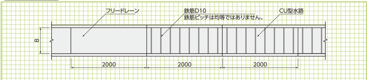
敷設平面図 (配筋及びコンクリート打設)
