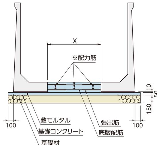
※配力筋にD10を使用している場合は、配力筋のピッチは125mm
