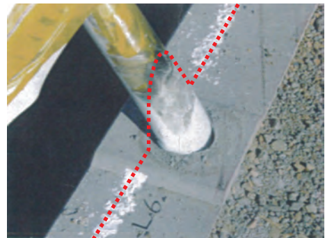
衝突試験 (車両の最大進入工程=140mm) においても車輪が擁壁から逸脱することがありませんでした。
