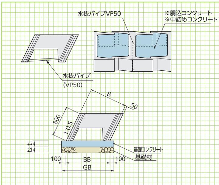
コンクリート基礎工による標準敷設材料表
