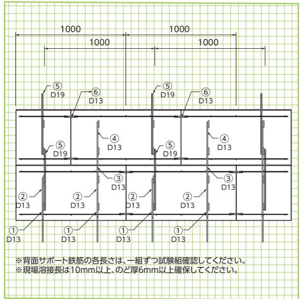
※背面サポート鉄筋の各長さは、一組ずつ試験組確認してください。
