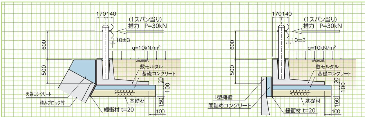
平面線形に合わせて施工する場合、曲率半径の大きさや、内カーブ・外カーブの別に応じて、製品天端内側に生じる隙間が車両用防護柵横梁の支柱取り付け孔の余裕代から35mm以下になるように設計してください。
