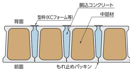
※中詰材は設計条件により現場発生材、コンクリートの使い分けができます。
