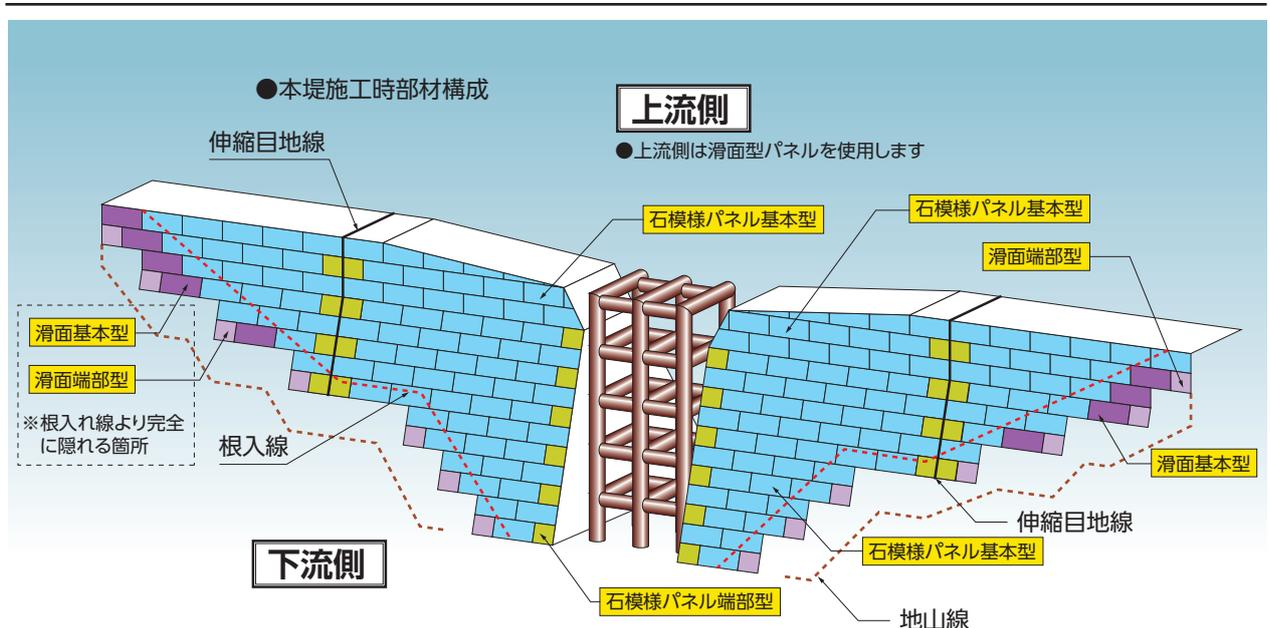
一枚岩模様基本型 参考重量:85kg/枚 コンクリート控除量(0.05m<sup>3</sup>/m<sup>2</sup>)
