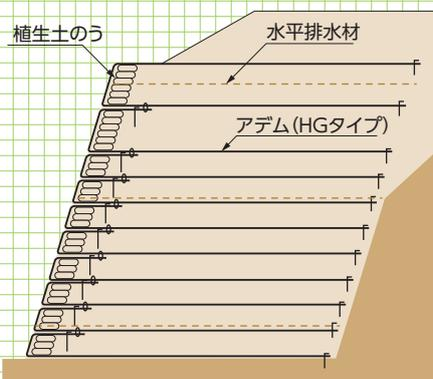
アデムHGを盛土内に敷設、法面部に法面ユニット(壁面材)や植生土のうを設置し、アデムで巻込む事によって、法面勾配が1:1.0以上の急勾配盛土を築造する事ができます。
