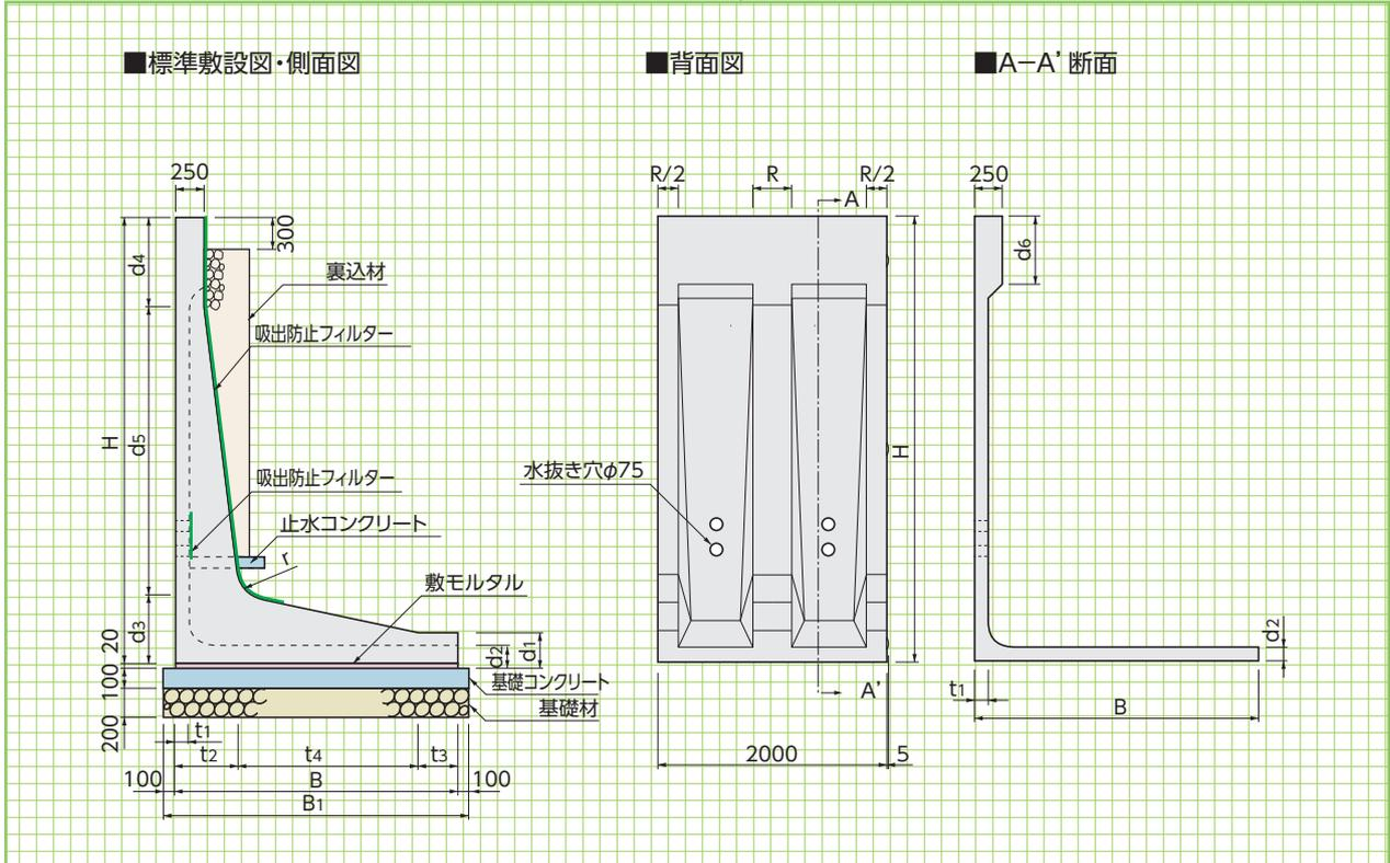
※裏込土の内部摩擦角は、 $40^\circ \geq \phi \geq 30^\circ$
