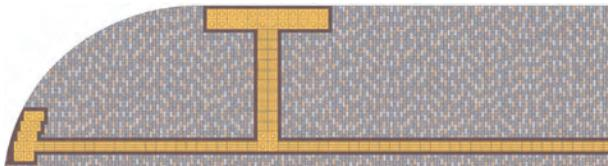
プラスチックの「サンド」「オーカー」を基調にした舗装パターンだが、「誘導ブロック」の両脇にスタンダードの「ダークブラウン」を敷設する事で、輝度比を強調。
