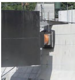
衝突実験 (NEXCO 試験法 441)にて、構造安全性を確認しています。
