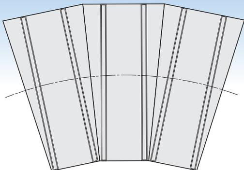
■下図に示すようにJSフォームをカットする場合、リップ部よりのとび出しの寸法は、200mmを最大とします。
