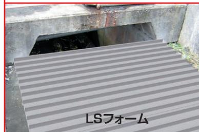
従来は、水路幅が1500～2500mmまでの大型水路の暗渠化には、水路に渡した等辺山形鋼にJSフォームを設置する「JSフォームアングル工法」で対応していましたが、LSフォームを使用することで、等辺山形鋼が不要になり、施工の簡素化が図れます。
