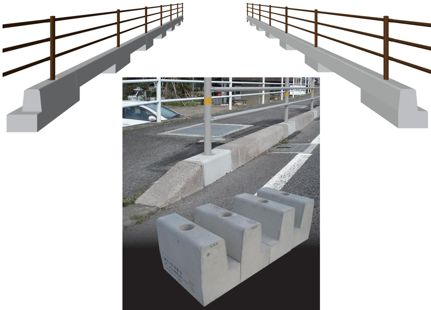
1. GPベースは歩車道境界ブロックと基礎が一体となっています。床掘り・基面整正、製品据付け、埋戻し、目地処理の簡易施工ですので熟練工を必要としません。施工性が向上し、工期短縮・早期開放が可能です。
