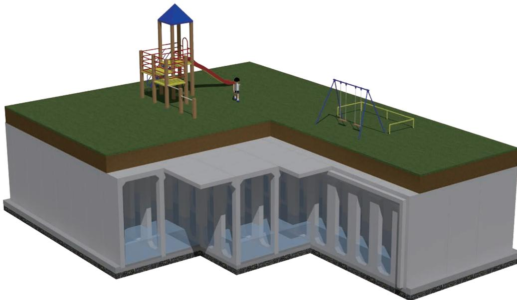
M.V.P.システムは、門型部材とスラブ部材を組み合わせ、底面部をインバート構造にすることで、勾配・溝やピットを設けることが可能となり集泥機能を有した、一般財団法人土木研究センター建設技術審査証明を取得した地下に構築される雨水貯留システムです。
