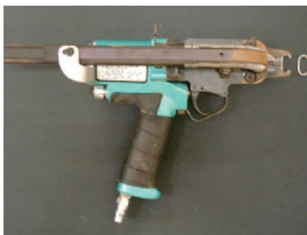
Cリンガー :MC-6C（電源が必要です） 専用のCリング結束工具・1.8kg/基
